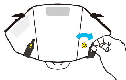
左右の固定用ベルトを外します。
